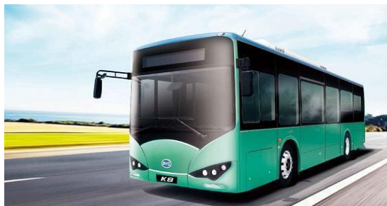
比亚迪 K8 类型: 纯电动 续航里程: 370 km 最大电量: 250 kWh
