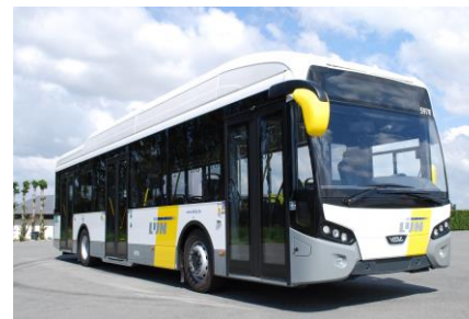
VDL Citea SLF-120 类型: 纯电动 续航里程: 600 km 最大电量: 216 kWh
