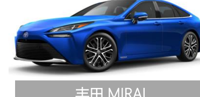
丰田 MIRAI 类型: Fuel Cell EV 最大里程: 575 km 氢气H2容量: 5.6 kg 电池容量: 1.24 kWh
