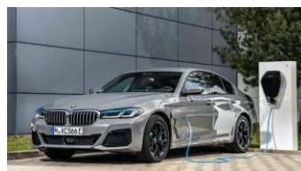
宝马 BMW 545e 类型: Plug-in Hybrid NEDC油耗: 1.5 L/100km 最大电池容量: 17.7 kWh
