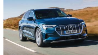
奥迪 Audi e-tron 类型: 纯电动 最大功率: 300 kW 最大电量: 95 kWh
