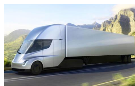
特斯拉 Tesla Semi 类型: 纯电动 续航里程: 804 km 最大电量: 500 kWh
