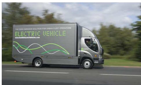
英国Smith EV (大宇Avia) 类型: 纯电动 续航里程: 241 km 最大电量: 120 kWh
